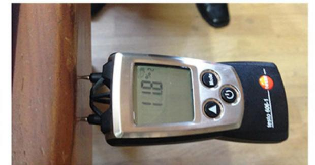
▲ 콘크리트 구조체 습기를 충분히 말리는 모습 / 나무의 함수율을 측정하는 도구
