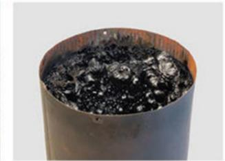
매립형 벽난로 설치 후 주변으로 열전도를 막기 위해 ALC 블록이나 불연내장재 등을 설치한다. / 굴뚝박스를 벽돌로 마감한 예, 굴뚝박스 주변으로 방수 후레싱도 설치한다. / 연도 내에 쌓인 크레소트의 실제 모습. 쌓인 크레소트가 화재를 유발하므로 연도 내 청소는 필수다.
