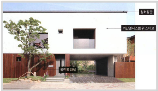
광주 주택 - 울린목 패널, 스티코, 0.8T 컬러강판 절제된 선과 비례감이 돋보이는 입면은 상부는 스티코, 하부는 울린목 패널을 두 톤으로 마감했고 패널을 따라 현관문 스틸 소재에도 세로걸을 입혔다.
